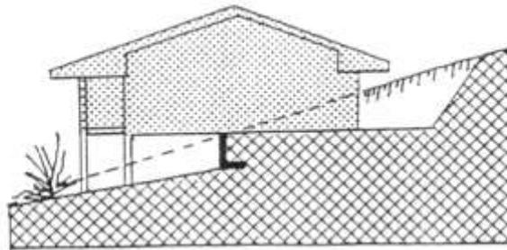
L'implantation de la construction doit tenir compte de l'accessibilité au garage en évitant les rampes d'accès des véhicules de plus de 20%. Il peut être intéressant de placer le garage en limite sur rue dans le cas de terrains très pentus.
