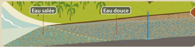
Un pompage raisonnable de l'eau douce, dans la nappe alluviale, permet de maintenir un équilibre naturel par l'apport régulier d'eau provenant des pluies et des cours d'eau.
