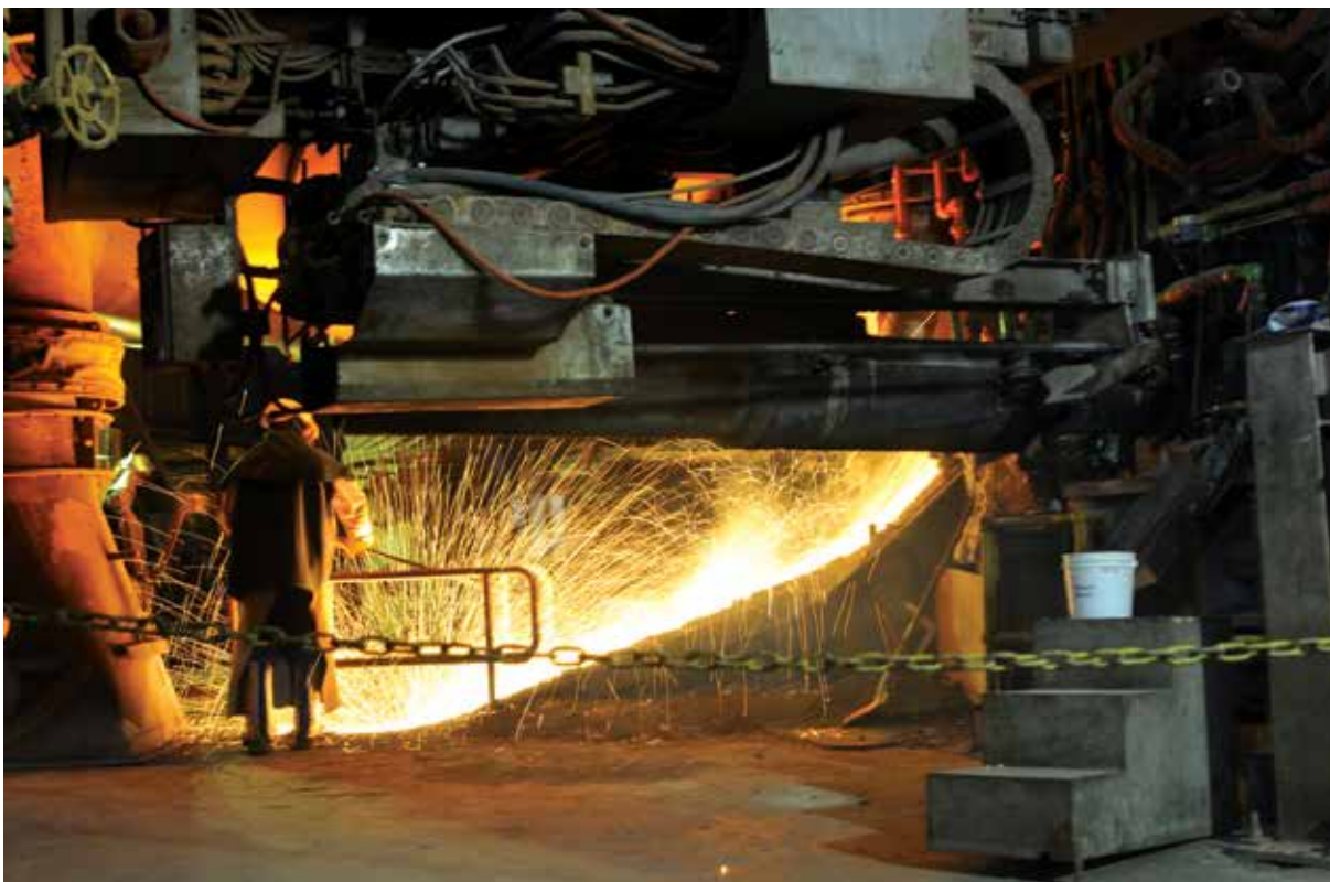
Équipés d'une tenue adaptée, les opérateurs percent l'opercule pour permettre au métal en fusion de s'écouler. Le spectacle est impressionnant !
