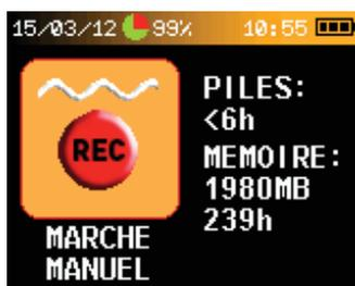
Cet écran ne montre que des informations sur l'état de l'appareil et permet de lancer l'enregistrement d'un examen manuellement. L'icône « MARCHÉ MANUEL » apparaît sélectionnée par défaut. Le patient ne peut pas modifier la configuration de l'appareil.
